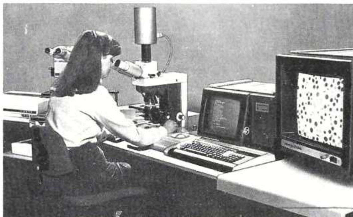
1 Bildverarbeitungssystem BVS Robotron A 6470 im Einsatzfall der Mikroskopbildanalyse
